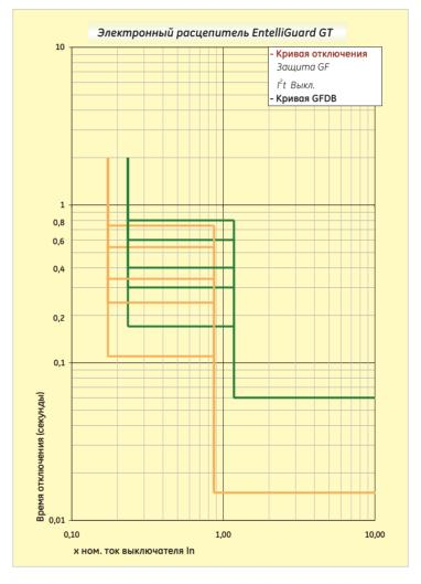
Пользователь может задать ток срабатывания защиты от замыкания на землю в диапазоне 0,2-1 х номинальный ток выключателя  $\ln c$  шагом 0,01 и выбрать один из 14-ти временных интервалов.
